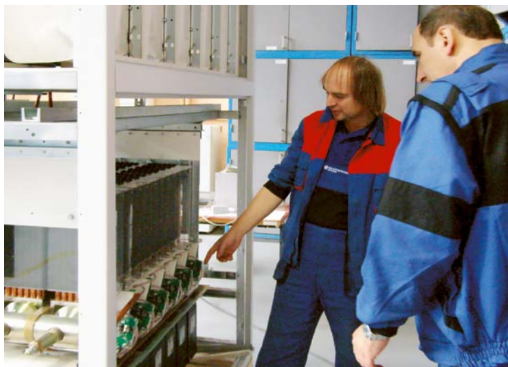
Mistr výroby Luděk Livora (vpravo) a zkušební technik Martin Kučera kontrolují výrobní postupy na rozpracovaném střídači INVERT, který patří mezi nově vyvinuté produkty ČKD ELEKTROTECHNIKA, a.s.
