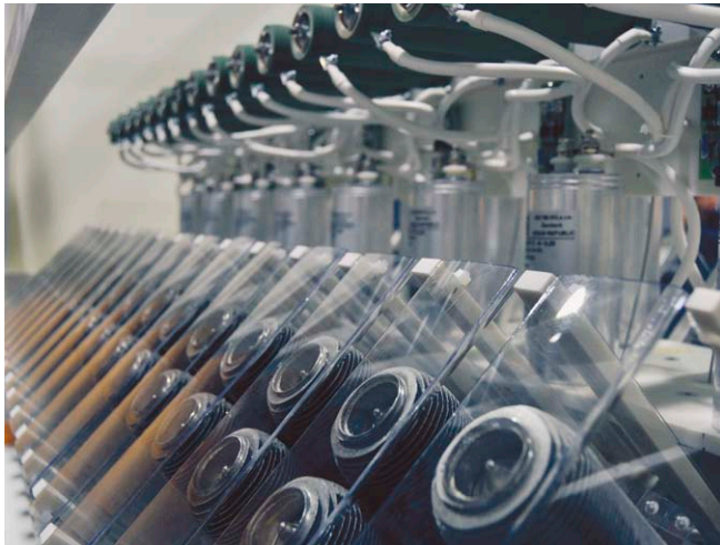
Detail bloku VN – pohled na tepelné trubice.
