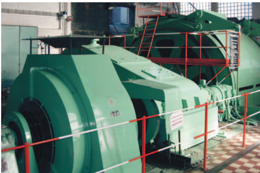
Těžní stroj se střídavým motorem – důl Lazy.
