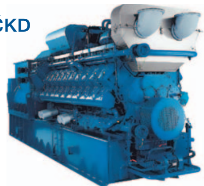
Kogenerační jednotky pro teplárny v České Lípě mají energetický výkon 2,014 MW a tepelný výkon 2,138 MW. Vstupním palivem je zemní plyn.
