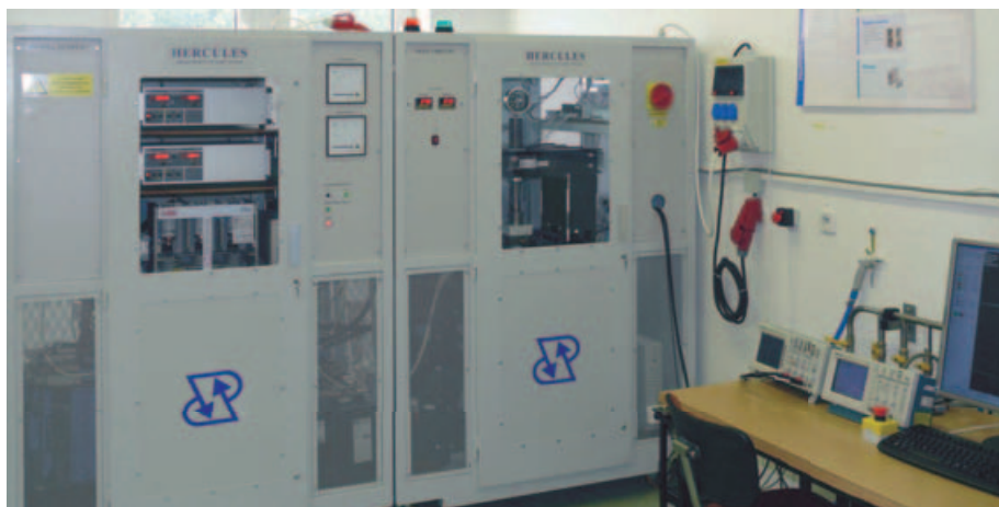
Srpen 2008, laboratoř NTU-Z již vévodí nový tester dynamických parametrů se jménem neporazitelného antického hrdiny – HERCULES.
