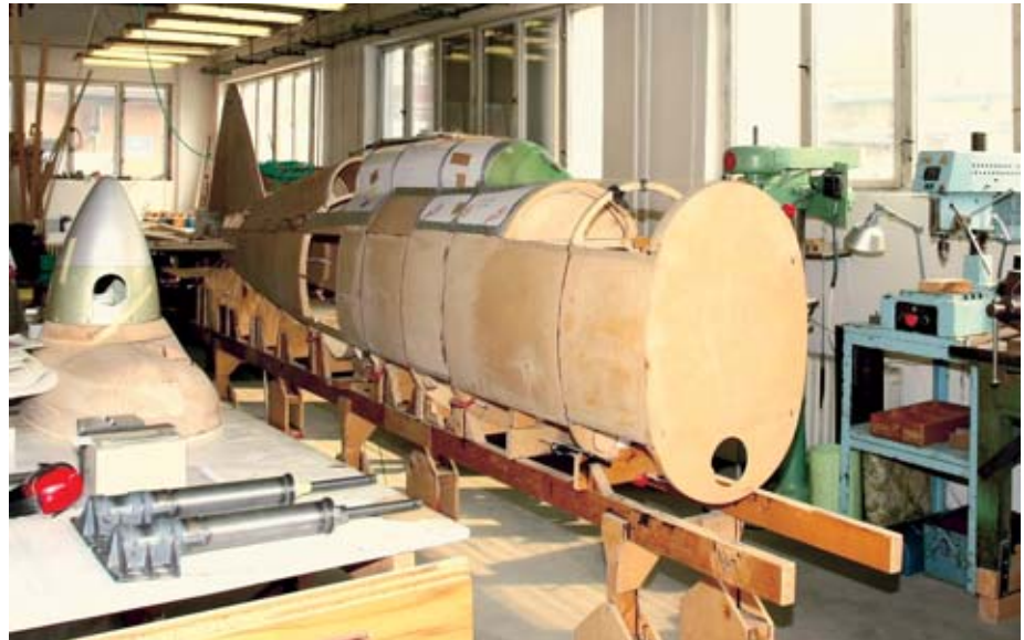
Фюзеляж «деревянного» самолета «Злин-ХIII» в помещениях «ČKD PRAHA DIZ».
