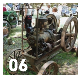
A.G. WIEN, rok výroby 1927, výkon 5HP, se používala k pohonu zemědělských strojů jako mlátičky obilí, drtiče, řezačky píce. Podobné parní stroje, ovšem stabilní, nepřevozná, se používaly k pohonu jiných mechanických zařízení jako např. katrů, strojů v dílnách (vrtaček, frézek, soustruhů, brusek apod.)
